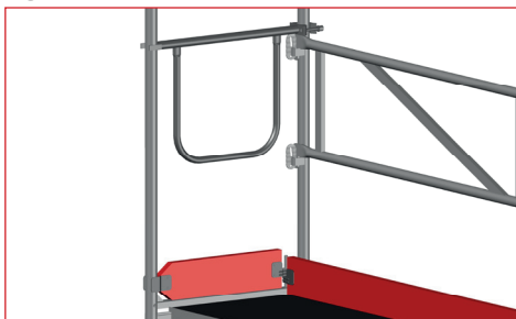
Fig. 2.17: Sikring med enderekker
