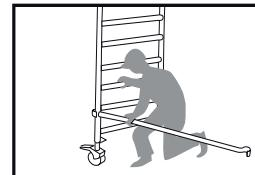
**4** Sett et horizontalstag i samme høyde på motsatt ende av rammen. Hvis du har et rullestillas med dobbel bredde (1,35 m), bruker du to horizontalstag i stedet for ett.
