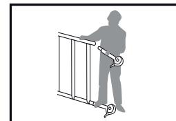
**3** Monter horizontalstag på rammens vertikale rør så nært horizontalstaget som mulig, og la den andre enden av staget hvile mot bakken. Hullet i kroken må ha åpningen vendt utover.
